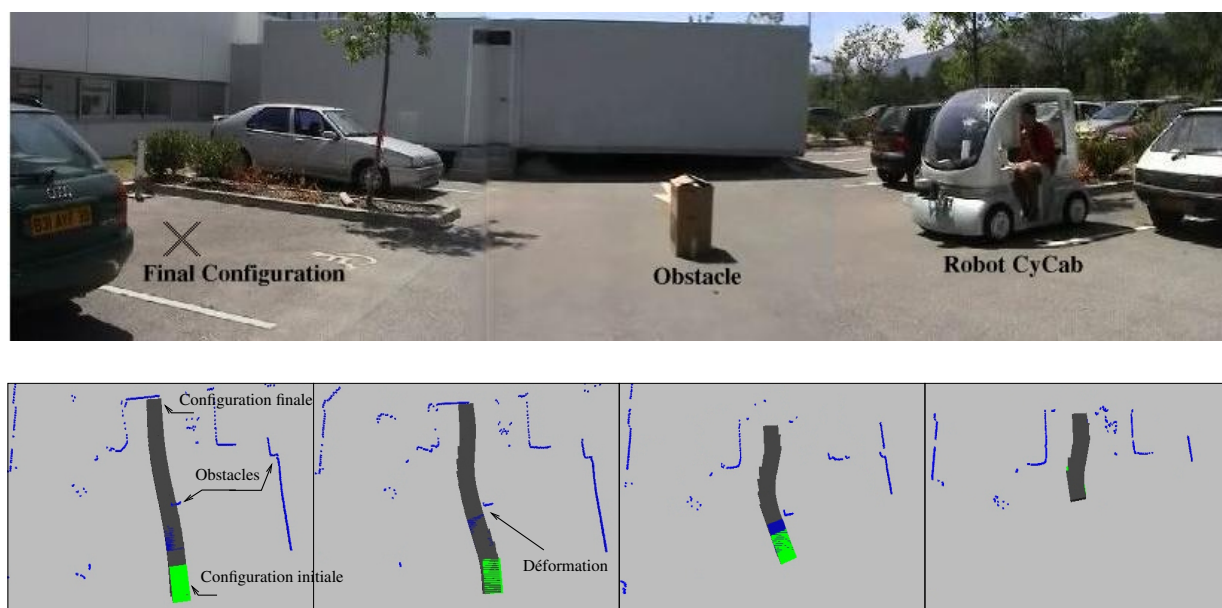
FIG. 6.2 – Expérimentation avec le robot Cycab. Sur la figure du haut, le cadre expérimental : une trajectoire est planifiée, depuis une place de parking vers une autre, mais un obstacle non modélisé se trouve sur cette trajectoire. Sur la figure du bas, on observe les déformations de la trajectoire au cours de son exécution.
